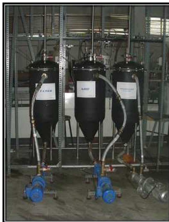
Fig. 1 Esquema de los digestores en monoetapa
