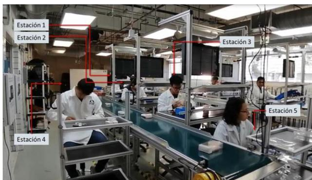
Figura 4. Distribución de la línea de ensamble- método estadístico
