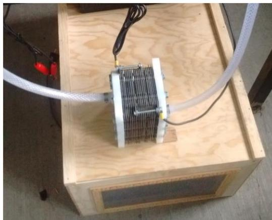
Figura 2. Electrolizar utilizado para producir hidrógeno.
