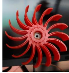
Figura 17. La hélice vertical realizada con una impresión 3D
