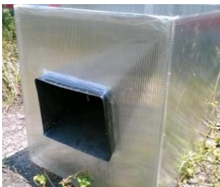
Figura 11.- Estructura con policarbonato sin colector
