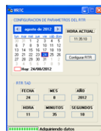
Figura 3c. Configuración del reloj en tiempo real.
