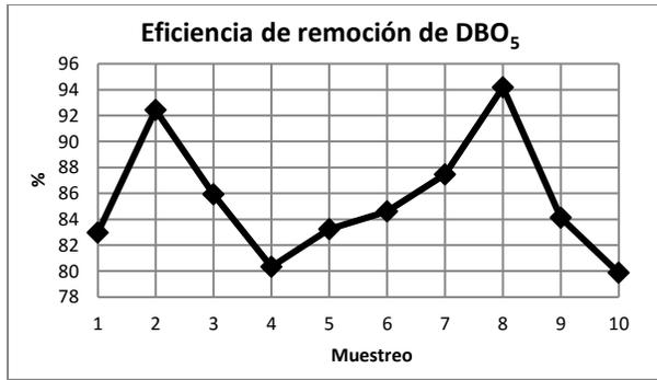
Figura 3. Eficiencia de remoción de DBO<sub>5</sub> durante el período de evaluación.
