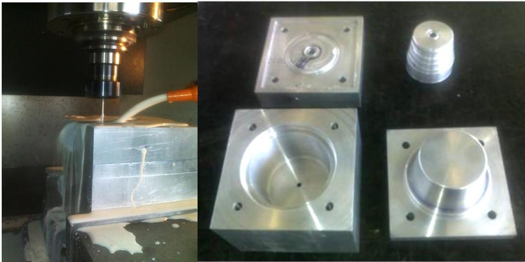
Figura 7. Maquinado y componentes del molde prototipo.
