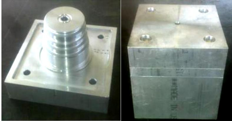
Figura 8. Ensamble del molde prototipo.
