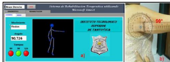
Figura 5. a) Flexión del brazo derecho b) Medición con el goniómetro.
