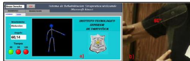
Figura 7. Abducción a) Panel frontal, b) con el goniómetro.
