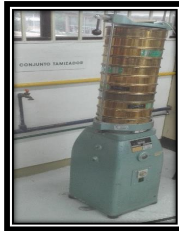
Figura No. 3 Tamizador en operación (Tyler).
