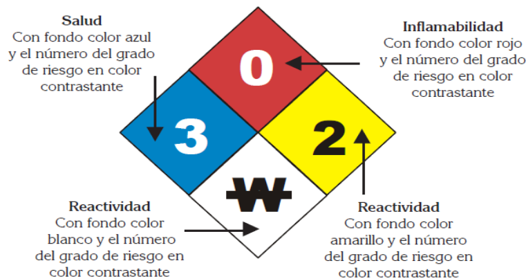
Figura 1. Rombo que representa el código NFPA oHommel, que representa el sistema de identificación de riesgos.
