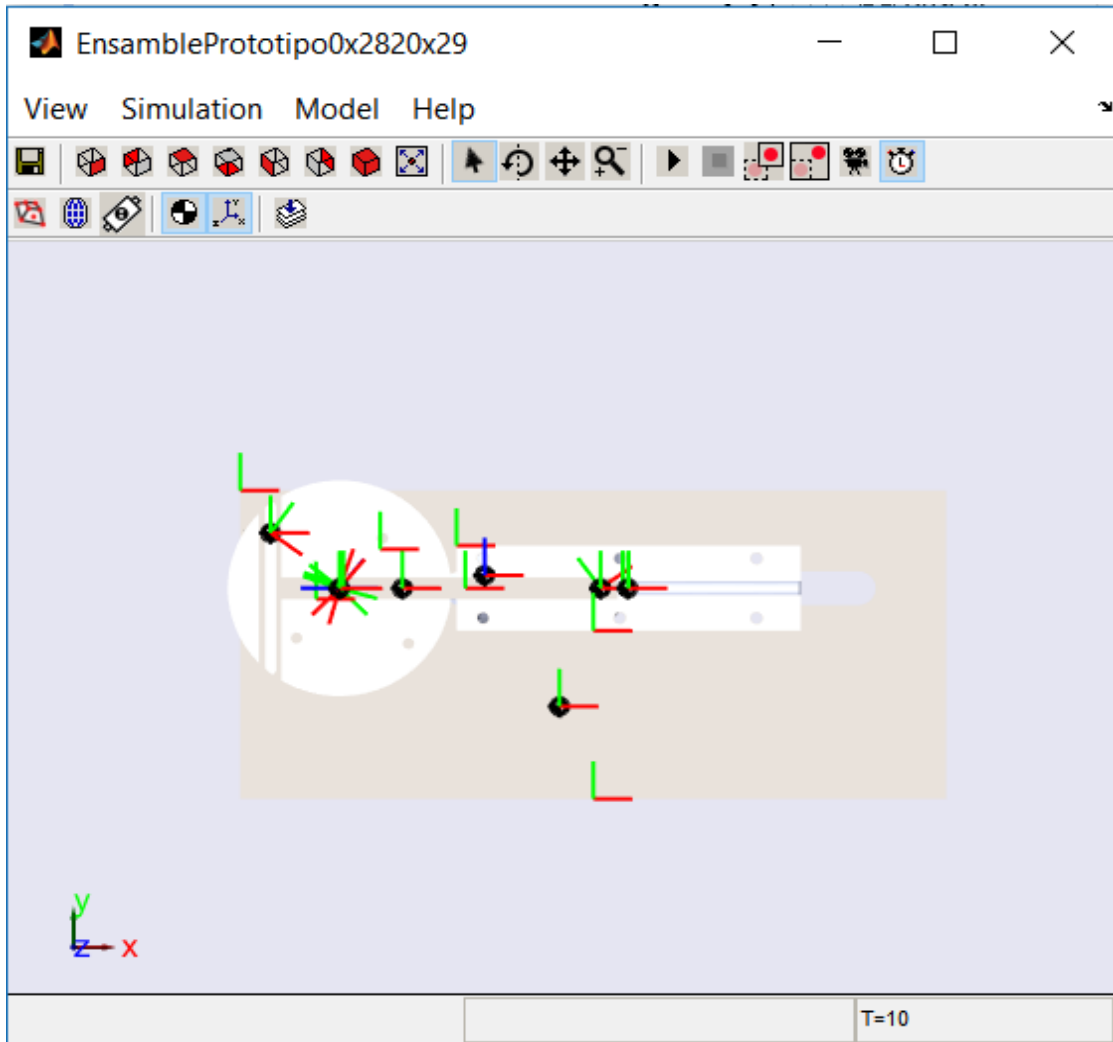
Figura 3. Mecanismo de Yugo Escocés simulado a través de Matlab.
