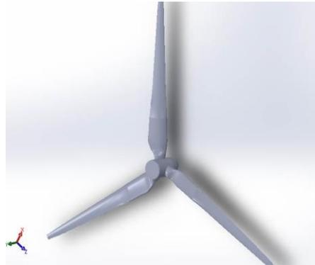
Figura 3. Geometría 3D de la pala bajo estudio diseñada en SolidWorks.
