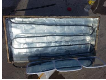
Figura 7. Calentador solar con reflectores. Elaboración: Propia.
