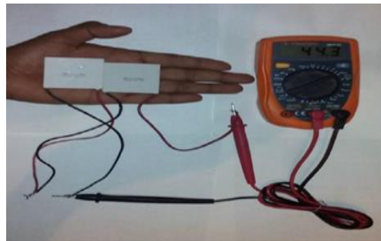
Figura 2. Prueba de voltaje del arreglo en serie.
