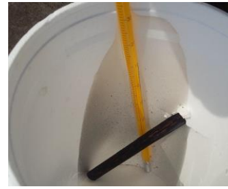
Figura 8. Temperatura del agua en la salida del calentador. Elaboración: Propia.
